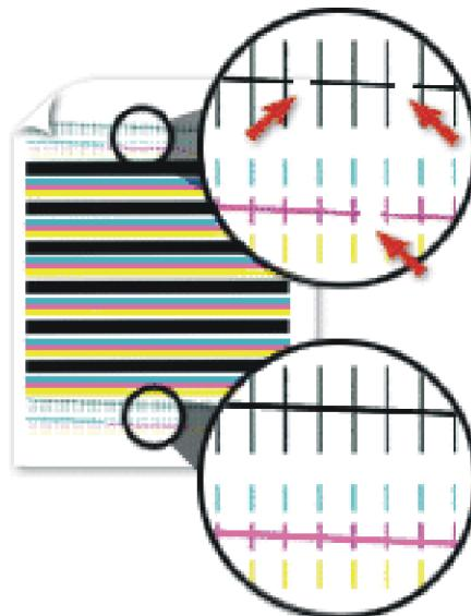
Vergleichen Sie die diagonalen Linien oberhalb der gedruckten Balken mit den Linien unterhalb der Balken. Suchen Sie oberhalb der gedruckten Balken nach Unterbrechungen in den diagonalen Linien. Unterbrochene Linien deuten auf verstopfte Düsen hin. Untersuchen Sie die diagonalen Linien unterhalb der gedruckten Balken auf Durchgängigkeit. Nicht unterbrochene Linien deuten auf saubere Düsen hin.
